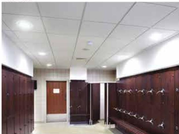
Los paneles de hasta 1.800 mm de longitud permiten dotar a salas o pasillos de una alta absorción y aislamiento, mientras que el material asegura la facilidad de la manipulación y la sencillez de la construcción.
