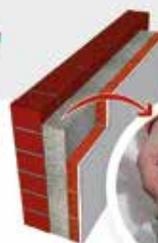
Cámara aislada con el sistema ThermaBead
